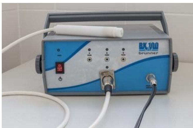
Figura 1- Gerador de pulsos para eletroquimioterapia com ponteira de aplicação
