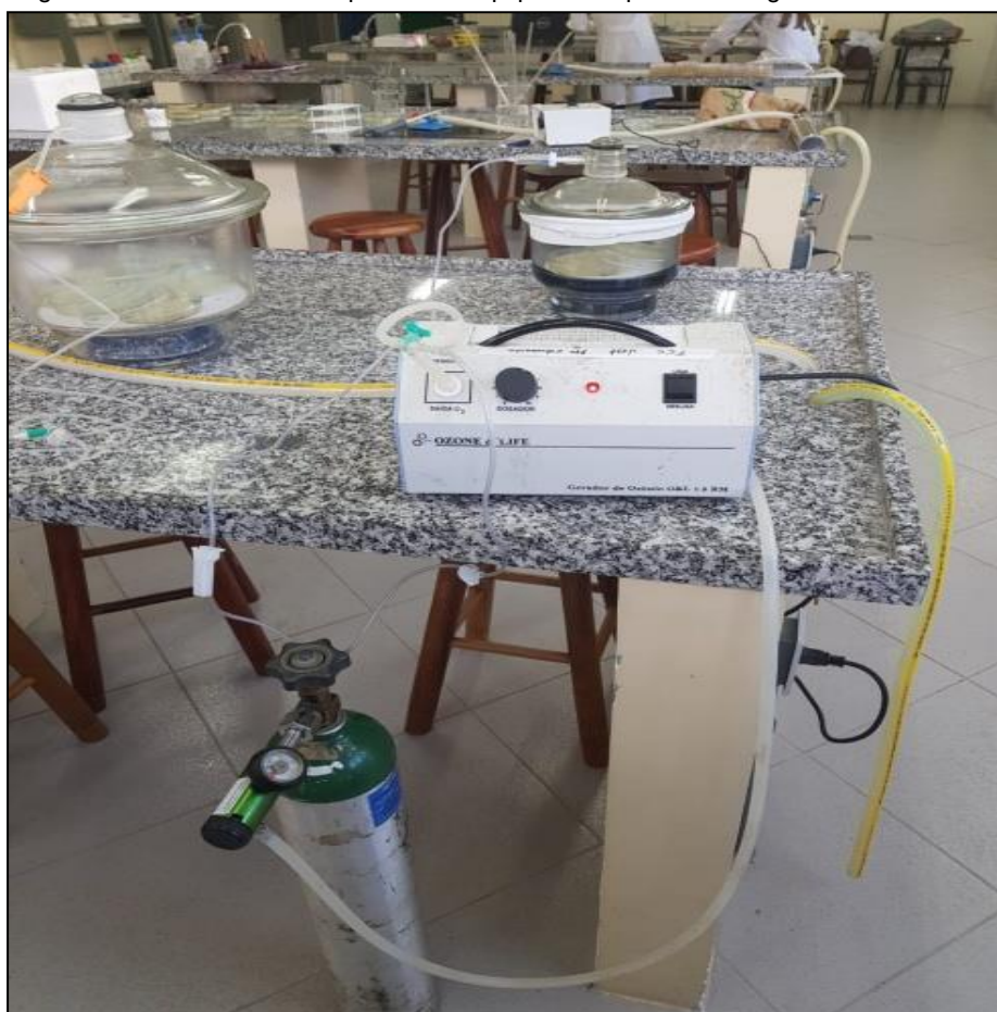
Figura 1 – Dissecadores acoplados ao equipamento produtor do gás Ozônio
