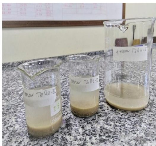
Figura 6 – Imersão da amostra em 60 mL de água destilada para leitura de pH
