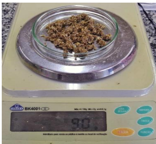
Figura 5 – Pesagem da amostra de bagaço de malte para posterior adição de água destilada e leitura de pH
