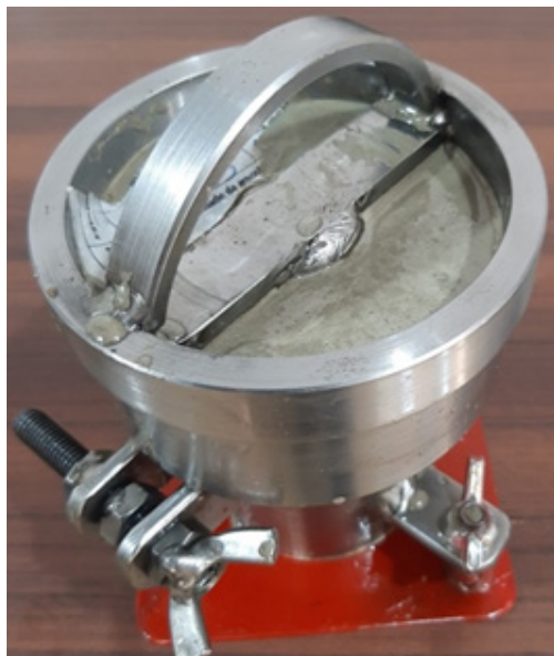
Fig. 3: Imagem da forma com enchimento de concreto para confecção do Corpo de Prova.
