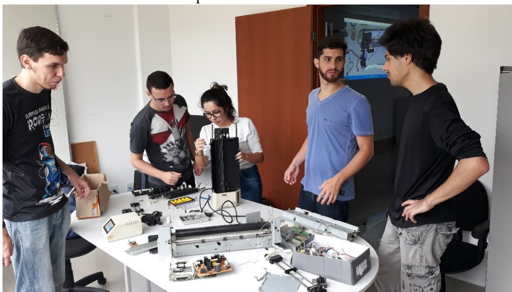
Figura 1: Desmonte da plotter LOGICAL LYTG-600/S para utilização de sua estrutura e componentes mecânicos.
