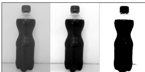
Figura 8. Imagens geradas pela rotina no MATLAB® do objeto correto: (a) Imagem real; (b) Imagem com pré-tratamento; (c) Imagem com tratamento para comparação e decisão.
