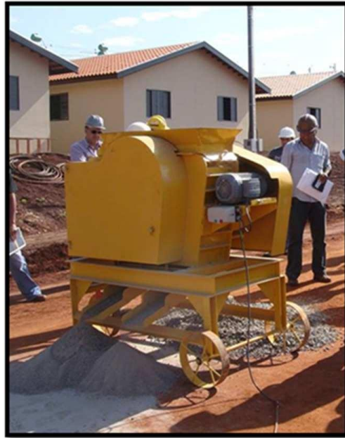
Figura 3 - Q400 RI, reciclador de RCD, pequeno e de fácil manutenção
