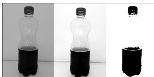
Figura 8. Imagens geradas pela rotina no MATLAB® do objeto correto: (a) Imagem real; (b) Imagem com pré-tratamento; (c) Imagem com tratamento para comparação e decisão.
