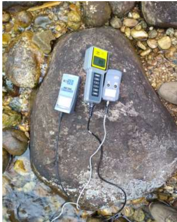
Figura 3 – Equipamentos para medição de Ph, Condutividade, Temperatura, Salinidade, etc.
