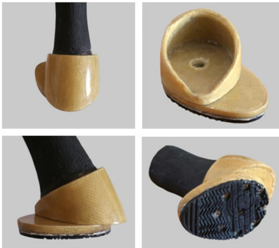
Figura 3 – Detalhe da paleta giratória acoplada na parte inferior da prótese
