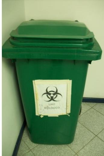
Figura 11: Resíduos biológicos. O recipiente está localizado no corredor do prédio, o ideal é que haja um local de armazenamento temporário na área externa e que o recipiente seja provido de tampa com trava e acionamento por pedal.
