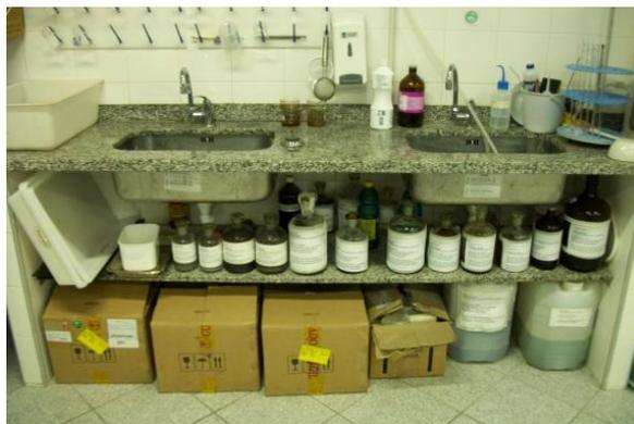
Figura 12: Resíduos e produtos químicos utilizados nos laboratórios de pesquisa e de estudos. O local de armazenamento deveria ser fora do laboratório, os rótulos não apresentam ícones e coloração que indiquem a classe do produto/resíduo, há ausência de portas neste local, aumentando o risco de acidentes.
