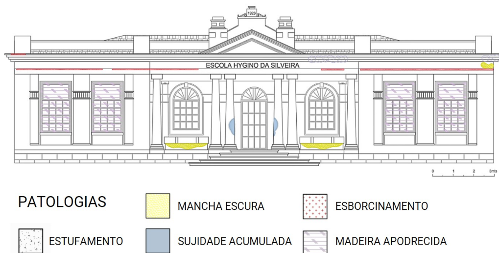
Figura 3- Mapeamento de danos Higino da Silveira
