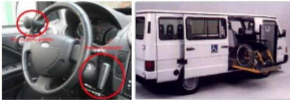
Adequações no automóvel para dirigir somente com as mãos e elevador para cadeiras de rodas.
