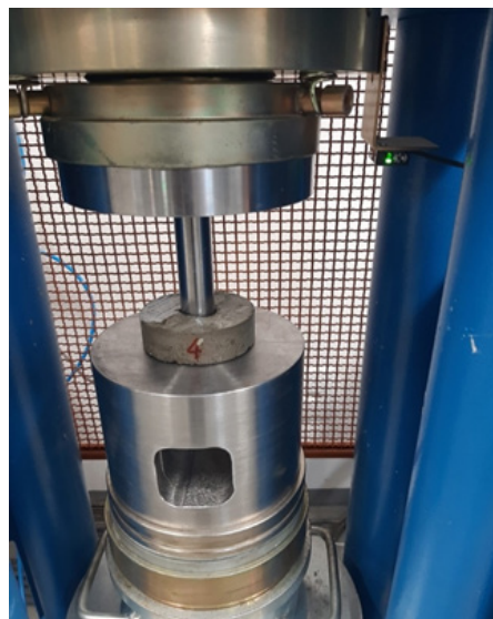
Fig. 9: Máquina de compressão adaptada com base, pistão e Corpo de Prova para teste.
