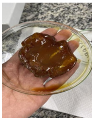
b) Em processo de secagem após alcalinização
