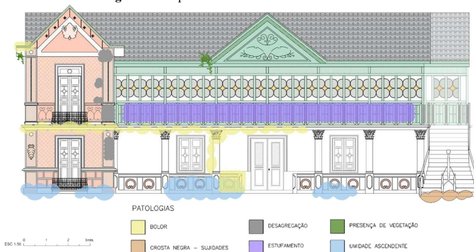
Figura 4 –Mapeamento de Danos da Fachada Frontal da CMAD.
