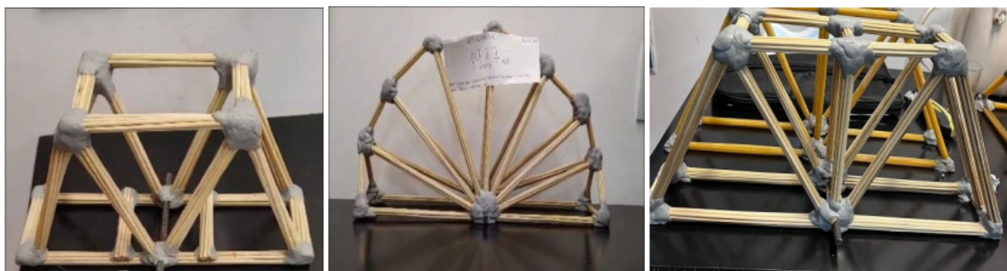
Figura 6: Pontes de Macarrão classificadas: (a) Primeiro lugar (38,97 kgf); (b) Segundo lugar (27,39 kgf)
