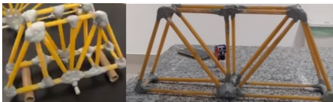
Figura 6: Pontes de Macarrão classificadas: (a) Primeiro lugar (38,97 kgf); (b) Segundo lugar (27,39 kgf)
