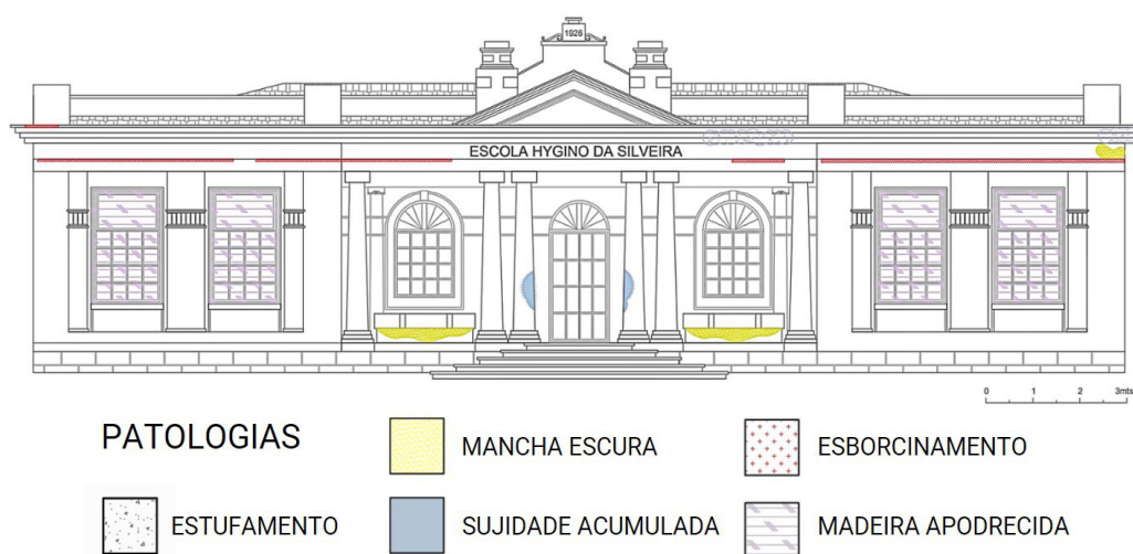
Figura 3 - Mapeamento de danos Higino da Silveira
