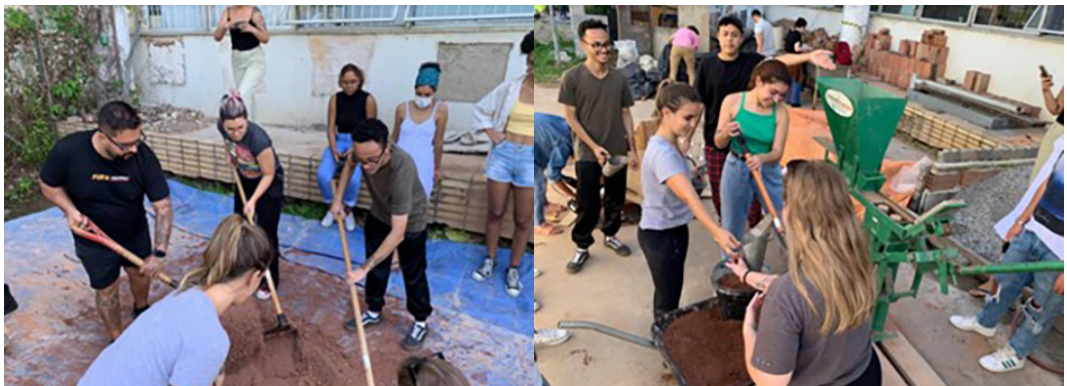
Figuras 11 e 12 – Produção de blocos de terra comprimida na Oficina de Integração Interinstitucional FAU/UFRJ e Unifeso no Canteiro Experimental da FAU/UFRJ
